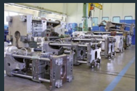
Lagerhaltige Austausch-Schließteile Replacement closing units are always in stock
